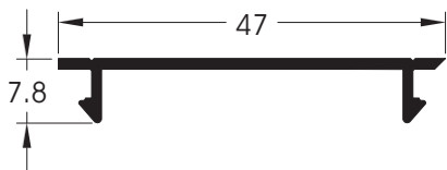
ΚΩΔΙΚΟΣ/CODE: 30-35 ΒΑΡΟΣ/WEIGHT: 215gr/m ΠΕΡΙΓΡΑΦΗ/DESCRIPTION: Καπάκι κάσας για ενσωματωμένη σίτα Cover for frame for hidden mosquito screen
