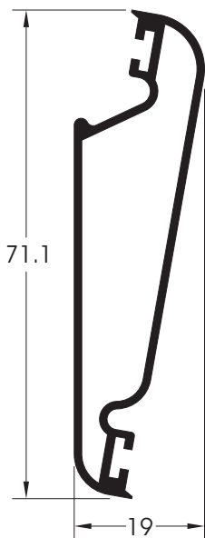
ΚΩΔΙΚΟΣ/CODE ΒΑΡΟΣ/WEIGHT Γ148 544gr/m ΠΕΡΙΓΡΑΦΗ/DESCRIPTION Πρόφιλ για κινητή περσίδα Moving louver profile
