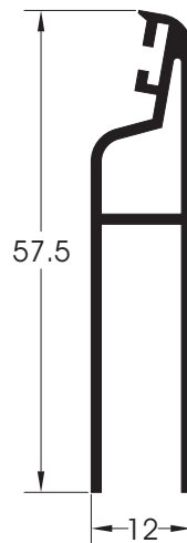
ΚΩΔΙΚΟΣ/CODE ΒΑΡΟΣ/WEIGHT Γ149 446gr/m ΠΕΡΙΓΡΑΦΗ/DESCRIPTION Τελείωμα για κινητή περσίδα Ending for moving louver
